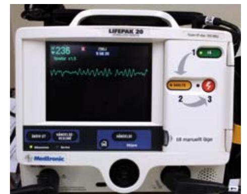
En ny lucka döljer de knappar som styr det manuella läget på defibrillatorer av typen Lifepak 20.
